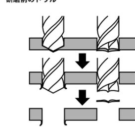
薄板の穴開けに最適な形状の一文字に研磨できる鉄骨用一文字ドリル研磨機です。普通のドリルで薄板に穴開け加工をすると、左図のように裏バリが出ますが、ドリル先端を一文字形状に研磨することにより裏バリが出にくくなります。
