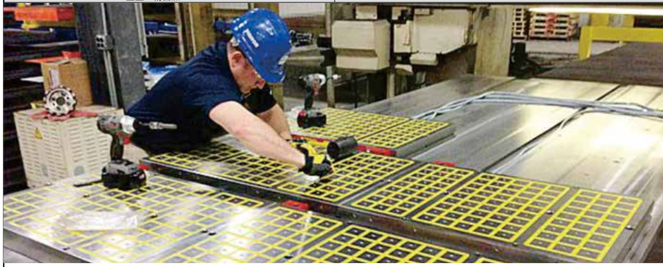
ダブルコラムマシニングセンターにて大型ワークの5軸加工に使用
